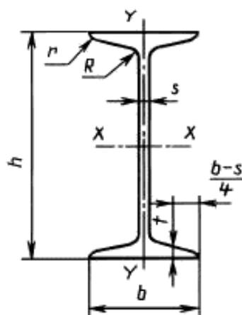
$h$  — высота двутавра;  $b$  — ширина полки;  $s$  — толщина стенки;  $t$  — средняя толщина полки;  $R$  — радиус внутреннего закругления;  $r$  — радиус закругления полки
